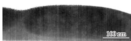
Рис. 3. ВКТД-СПЭМ-изображение эллипсоидного домена в сечении фотоактивного слоя \text{PTB7}:\text{PC}_{71}\text{BM} .
